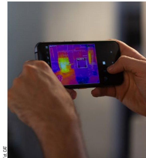
Smartfon ze wzmocnioną obudową, np. CAT S62 Pro, może być wyposażony w kamerę termowizyjną FLIR.
